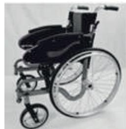
Dépliez le cadre du fauteuil roulant avec les deux mains en appuyant sur le siège pour permettre au fauteuil roulant de se déplier complètement.
