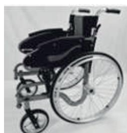
Het frame van de rolstoel uitklappen door met de beide handen de zitting naar beneden te drukken totdat hij volledig is ontvouwt.
